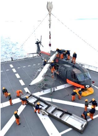
＜飛行甲板での ブレード取付作業＞ 海幕公式サイトから転載
